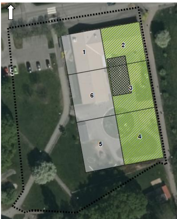
Figur 4. Tidigare åtgärdade rutor markerade i grönt. Grå rutor visar områden som ej har schaktats förutom för ledningsgravar under byggnad. Återanvända massor från ruta 1 och 6 visas som svart rutnät i ruta 2 och 3.
