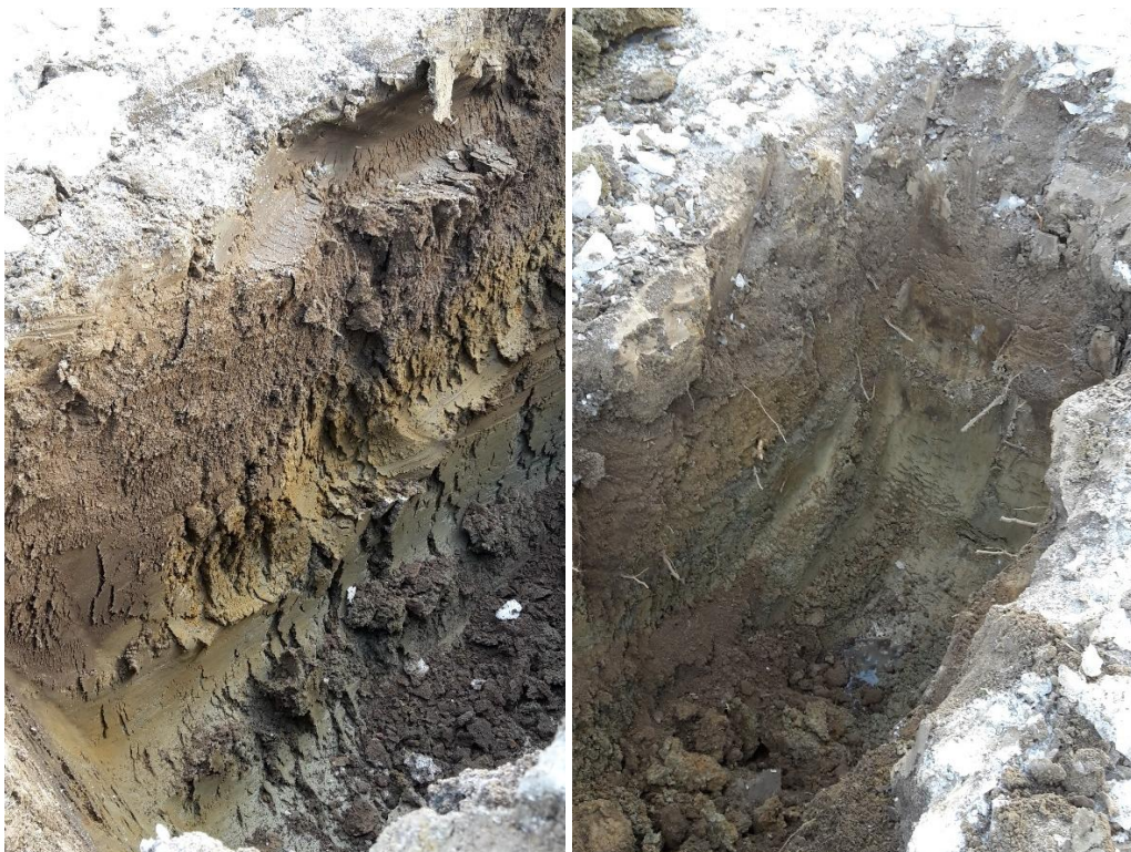
Figur 6. T.v. provgrop 1803 med mulljord ner till 0,3 m vilken underlagras av sand som övergår i lera. T.h. provgrop 1807 med mulljord ner till 0,5 m vilken underlagras av lera. På bilden syns vatten som tränger fram i botten av gropen.
